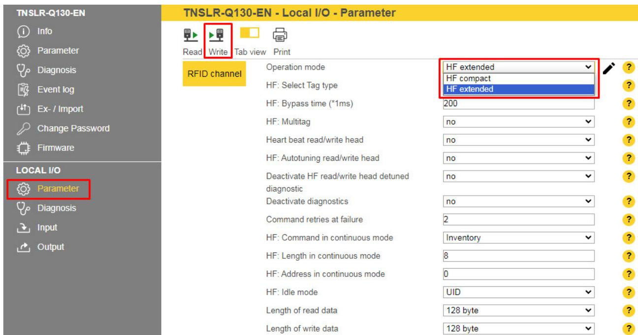
Fig. 40: Setting parameters in the web server
