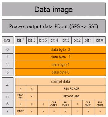
Fig. 42: Process output data
