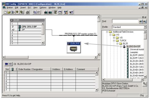
Fig. 12: Inserting a BL20-E-GW-DP
