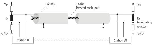
Fig. 1: Schematic PROFIBUS-DP cables
